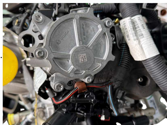
Bomba de vácuo ainda no local
